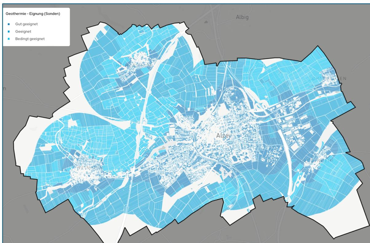
Abbildung 33: Geothermie-Eignung anhand oberflächennaher Kollektoren
