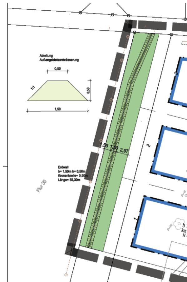
Abbildung 18: Vorkehrungen gegen Außengebietswasser bei Starkregenereignissen
